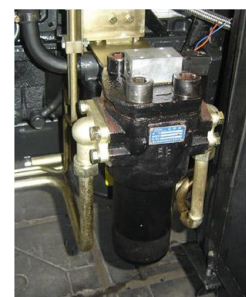
Рис. 4-11. Фильтр контура высокого давления гидравлической системы
