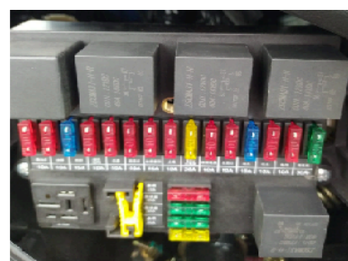
Рис. 2-77. Центральный коммутационный блок
